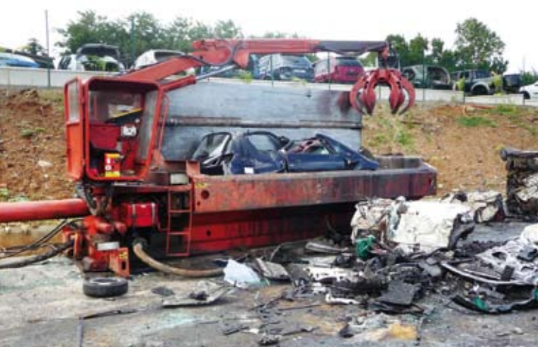
Presse hydraulique transformant la carcasse en VHU compacté.
