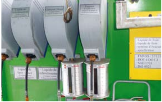
Équipement de récupération des fluides (huile, liquide de frein...)
